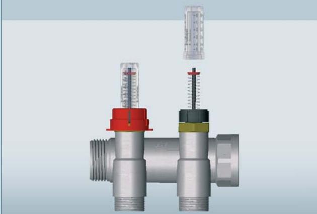
**SMONTAGGIO DELL'INDICATORE CON SCALA:** è possibile smontare l'indicatore con scala per lavori di manutenzione o sostituzione. A tale scopo è necessario chiudere la mandata ed il ritorno del circuito interessato e svitare l'indicatore (è possibile una minima fuoriuscita di acqua) pulirlo o sostituirlo con l'apposito pezzo di ricambio.
