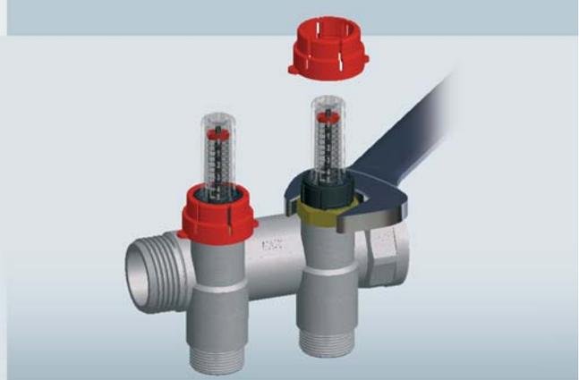
**MANUTENZIONE:** nel caso di rottura o mal funzionamento del flussimetro, è possibile procedere alla sostituzione dello stesso. Per fare questo, rimuovere il cappuccio antimanomissione, svitare il flussimetro con una chiave da 24mm e sostituirlo con uno funzionante, applicando una coppia di serraggio non superiore ai 20 Nm.
